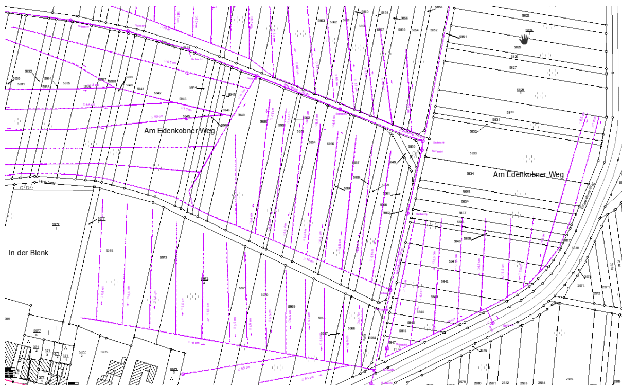
Abbildung 40 Drainagen und Verrohrungen im Bereich der Weinberge zwischen Rhodt und Edenkoben
