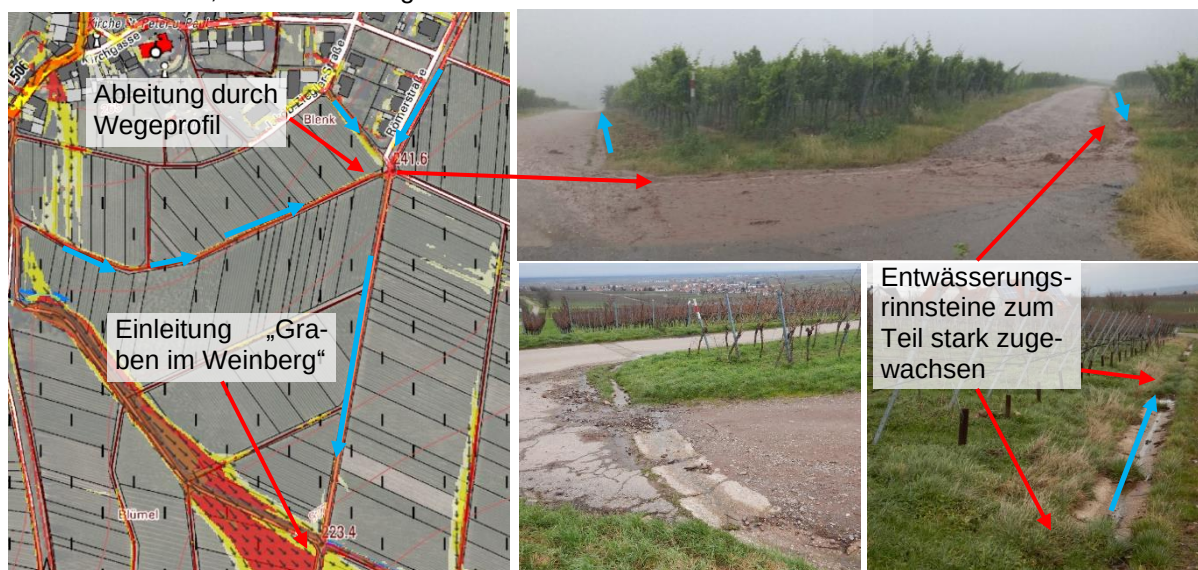
Abbildung 33 Situation Starkregenabfluss und Wegerosion im Bereich südlich Römerstraße
