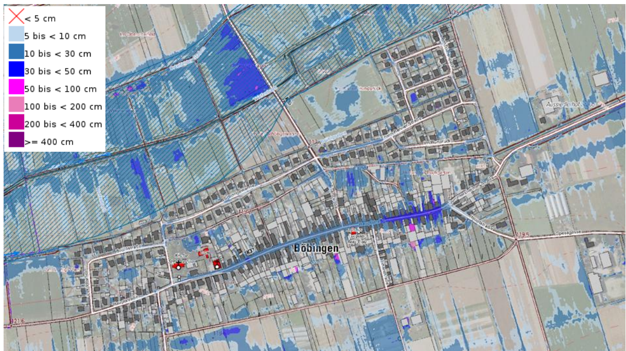
Abbildung 1 Sturzflutgefahrenkarte im Bereich der Ortslage von Böbingen (Wasserstand SR17)
