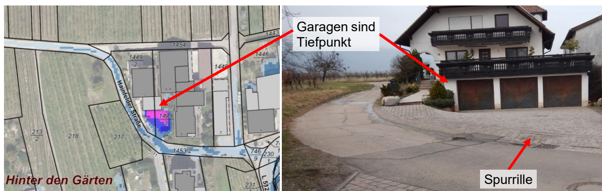
Abbildung 23 Außengebietszufluss Hainfelder Straße und Tiefpunkt Garagen Nr. 10
