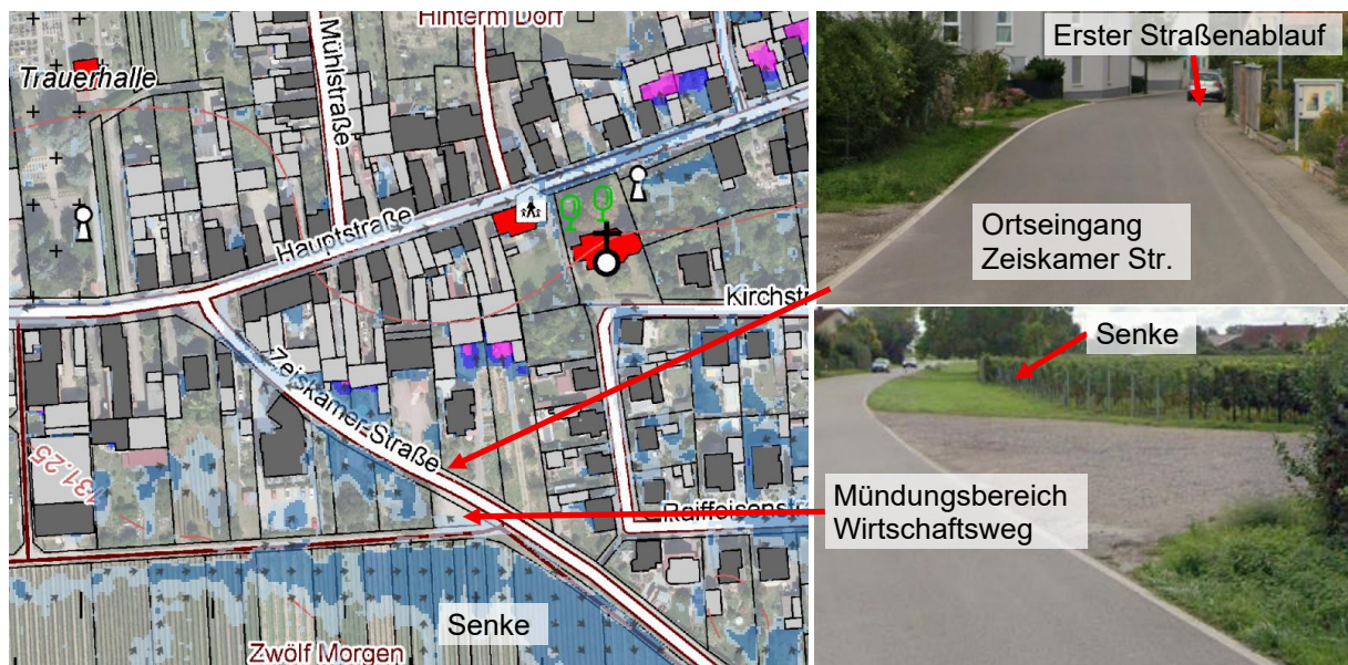
Abbildung 13 Außengebietszufluss Zeiskamer Straße
