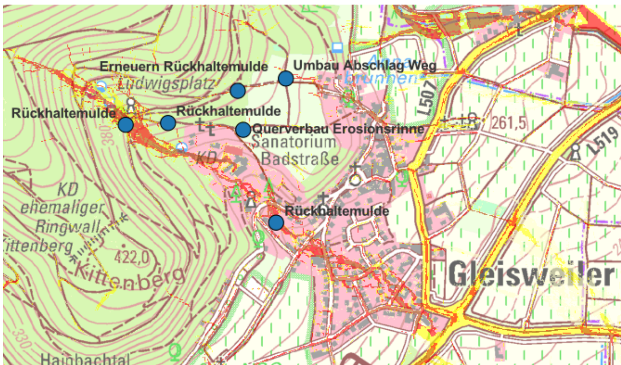
Abbildung 35 mögliche Rückhaltemaßnahmen im Wald bei Gleisweiler
