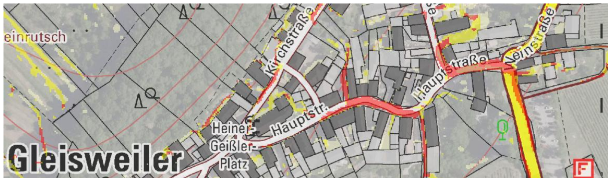
Abbildung 31 Starkregenabfluss Hauptstr. (Fließgeschwindigkeit SRI 7)
