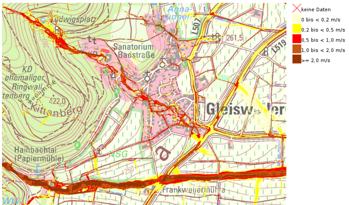
Abbildung 2 Sturzflutgefahrenkarte im Bereich der Ortslage von Gleisweiler Fließgeschwindigkeit
