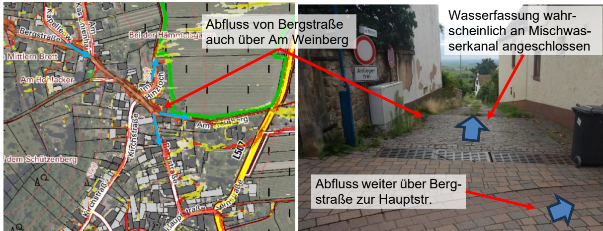
Abbildung 30 Starkregenabfluss Am Weinberg
