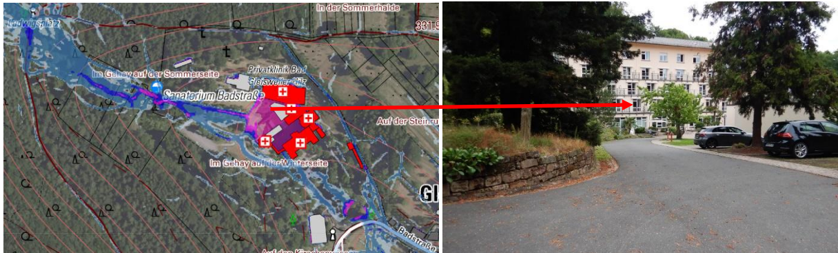
Abbildung 10 berechnete Wassertiefen (z.T. über 2 m) bei SRI 7 im Bereich des Sanatoriums
