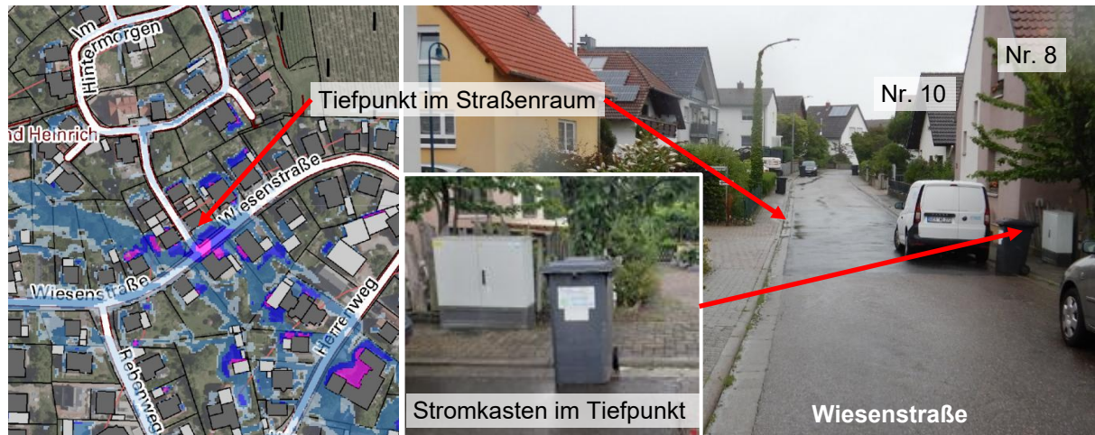
Abbildung 19 Überflutungsgefährdung Kreuzungsbereich Wiesenstr. / Im Hintermorgen
