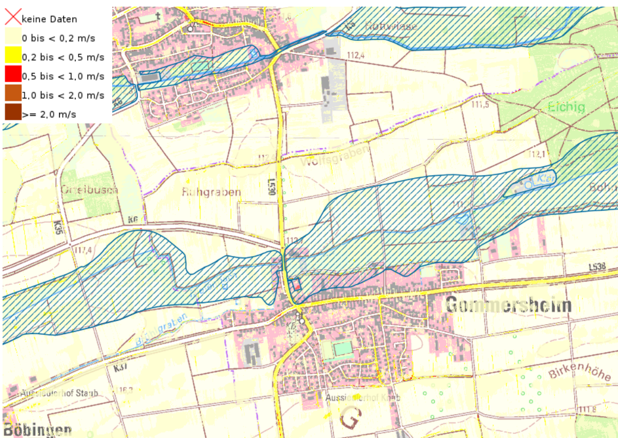
Abbildung 2 Sturzflutgefahrenkarte im Bereich der Ortslage von Gommersheim (Fließgeschwindigkeit SR17)
