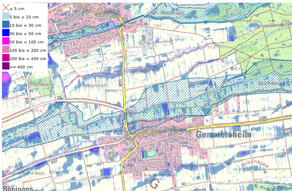
Abbildung 1 Sturzflutgefahrenkarte im Bereich der Ortslage von Gommersheim (Wasserstand SR17)
