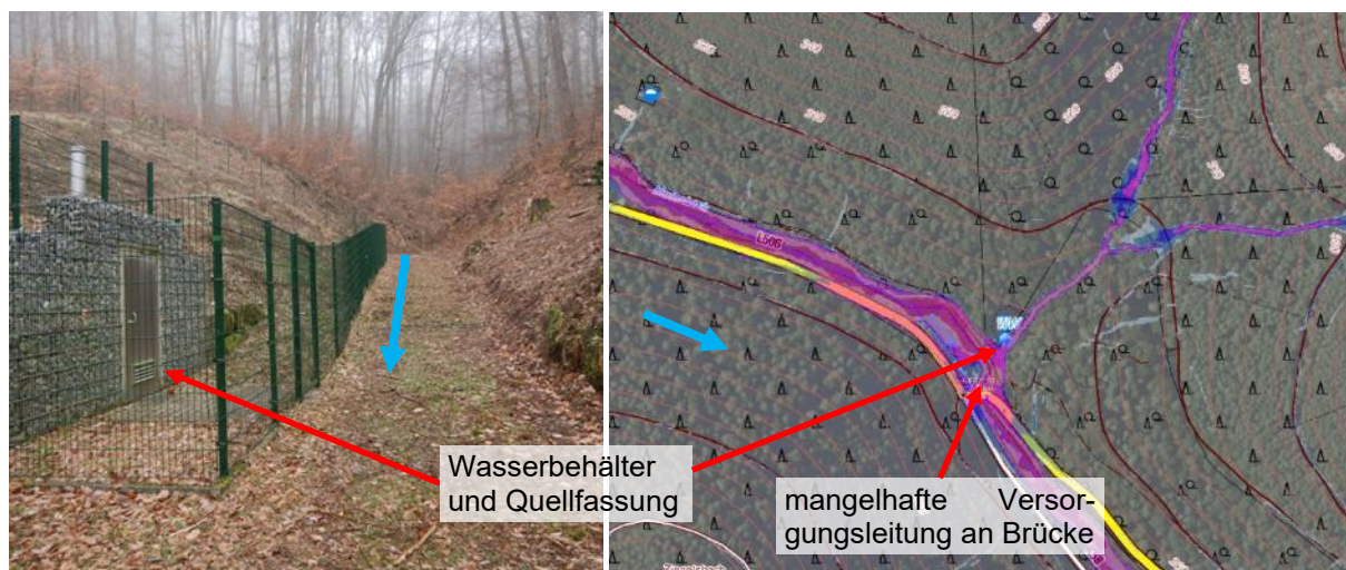
Abbildung 10 Situation Quelfassung und Wasserbehälter (Neuer Brunnen)
