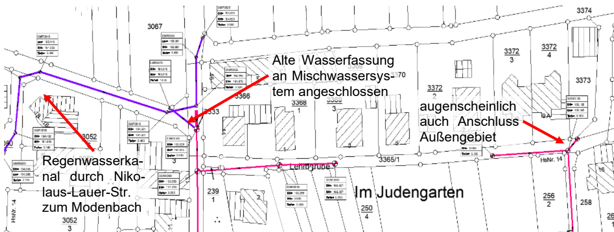
Abbildung 33 Kanaldaten im Bereich Lehmgrube / Marquardstraße
