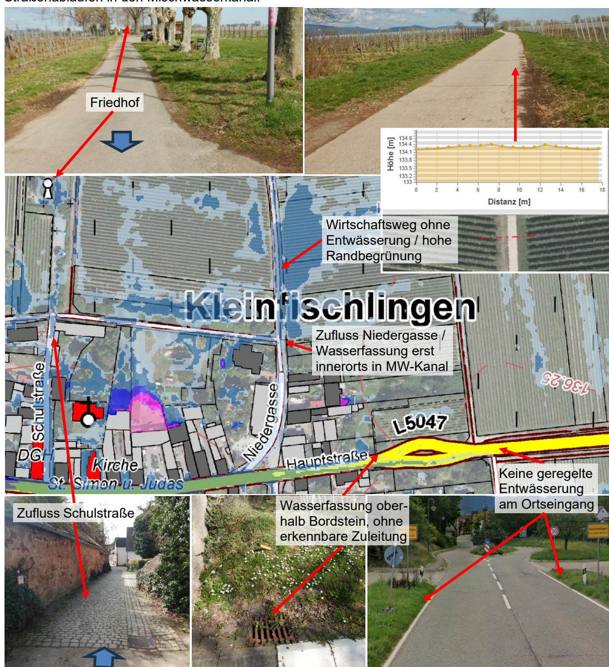
Abbildung 9 Situation Außengebietszufluss Nordost und Entwässerung L507
