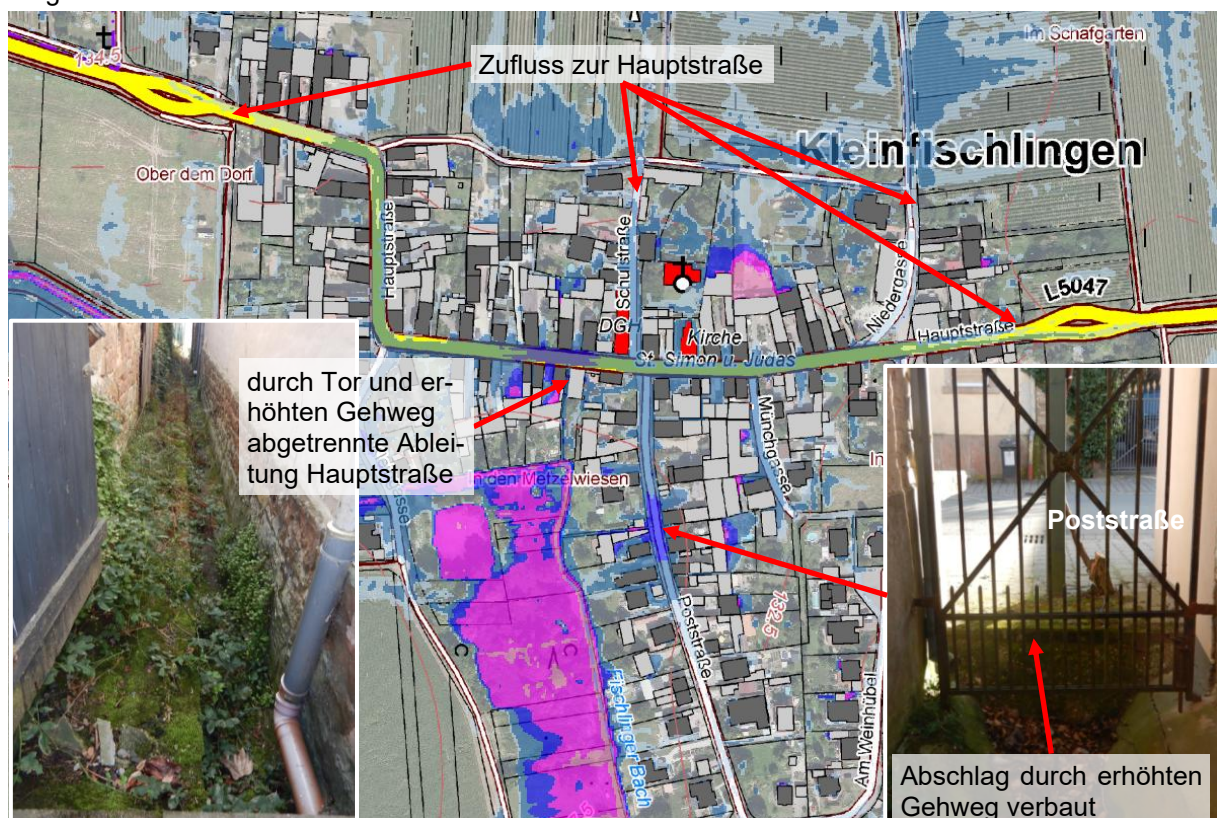
Abbildung 12 Überflutungsgefährdung Haupt- und Poststraße
