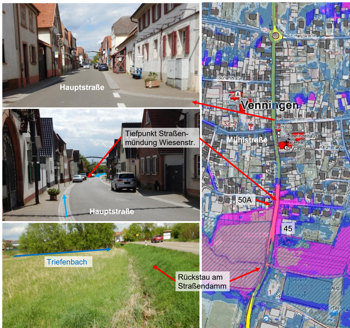
Abbildung 21 Überflutungsgefährdung und örtliche Situation Hauptstraße Venningen
