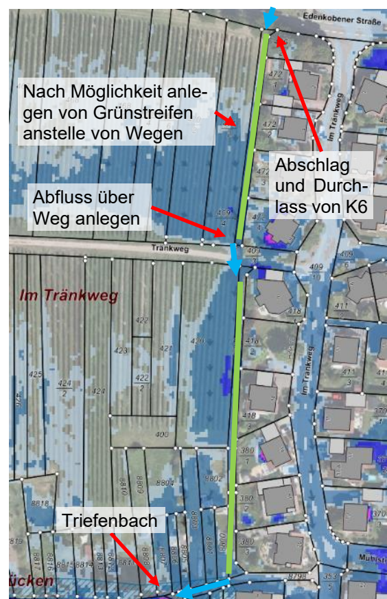
Abbildung 16 Überflutungsgefährdung (SRI 7) „Im Tränkweg“
